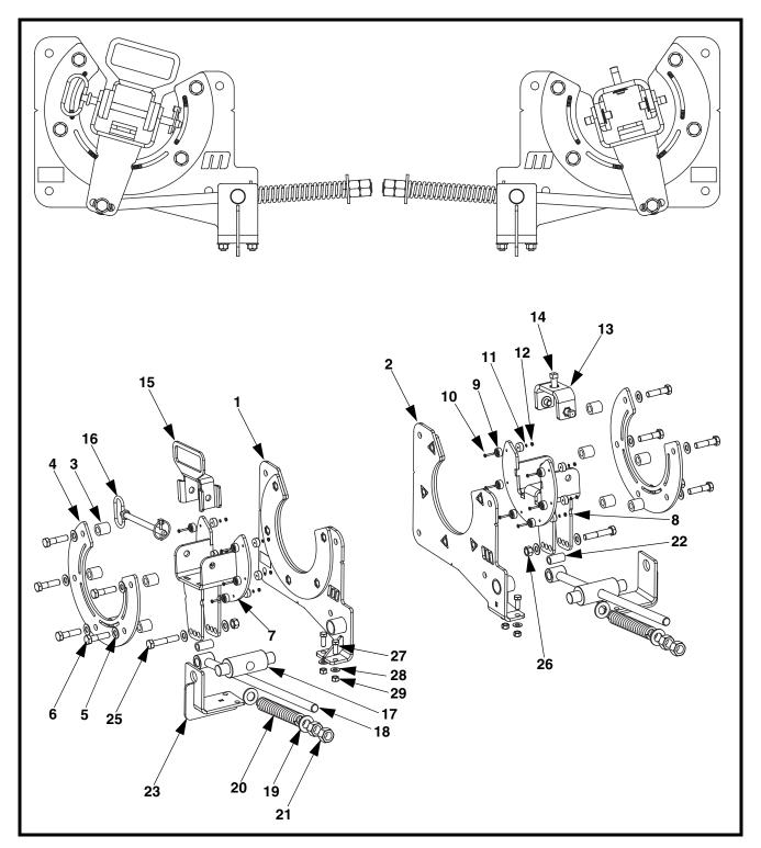
Figure 11. Martin<sup>®</sup> Spring Tensioner HD STS, P/N 39100-HDS
