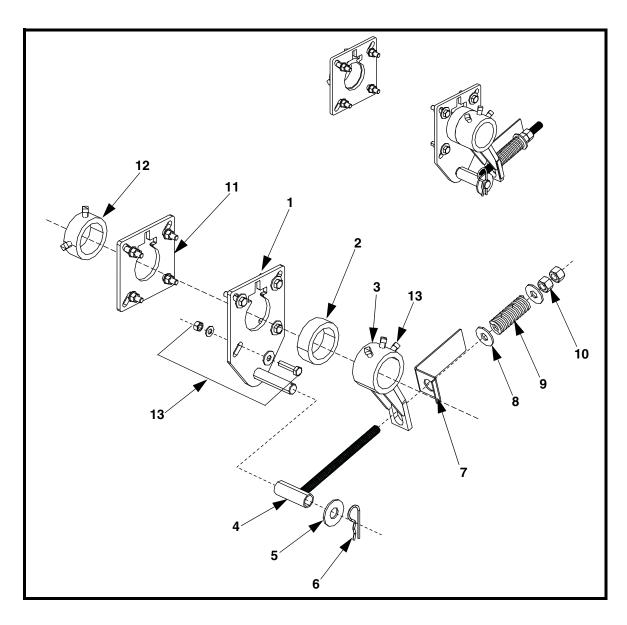
Figure 7. Martin<sup>®</sup> Spring Tensioner, P/N 38555-X
