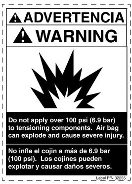
Figure 15. Air Bag Warning Label, P/N 32255
