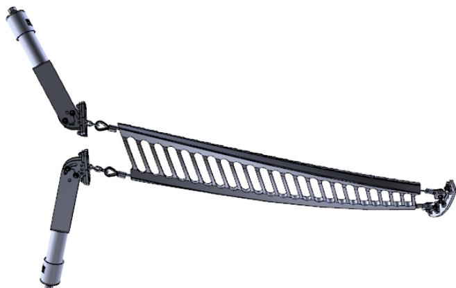
Очиститель **CleanScrape®** устанавливается диагонально относительно разгрузочного барабана и образует трехмерную кривую. Во время процесса вулканизации в резиновый корпус очистителя встраивают скребки из карбида. Несмотря на относительно низкое контактное давление между лентой и очистителем, удаляется 85-95% прилипающего материала.
