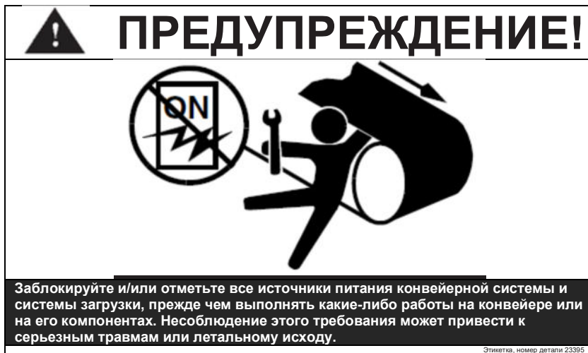
Рис. 11. Предупреждающая этикетка по эксплуатации конвейера, н/д 23395
