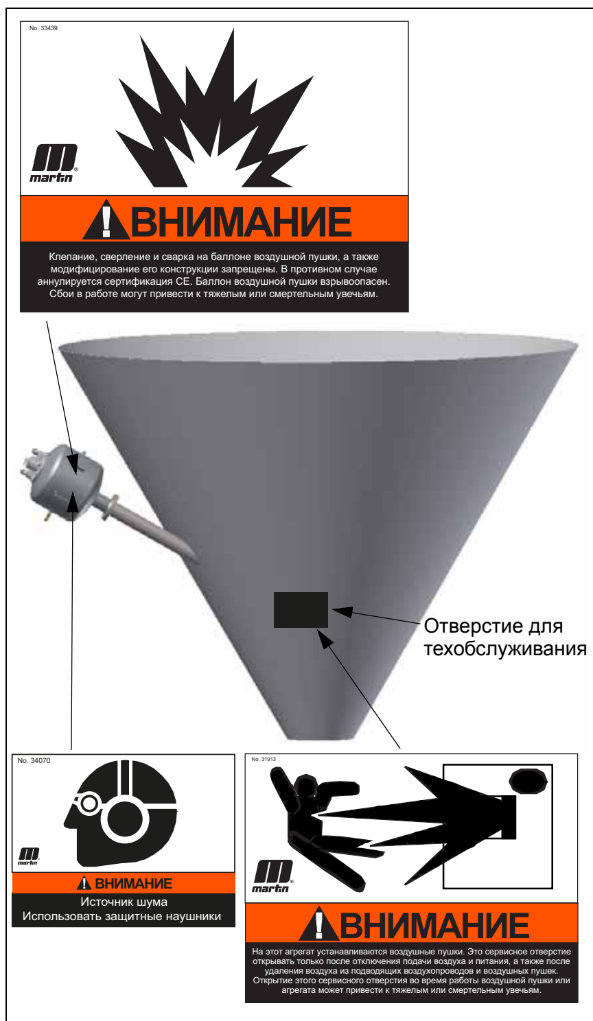
Рис. 12: Наклейка с предупреждением для воздушной пушки MARTIN® Hurricane
