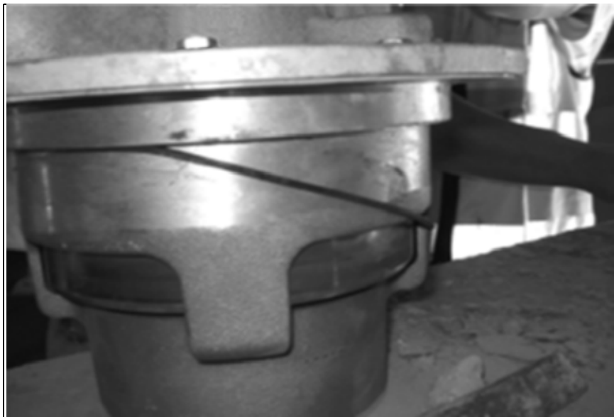
Рис. 18: Смазывание уплотнительного кольца
