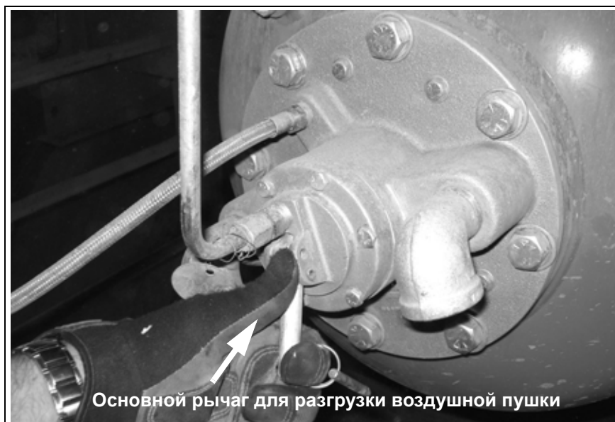
Рис. 13: Разгрузка воздушной пушки
