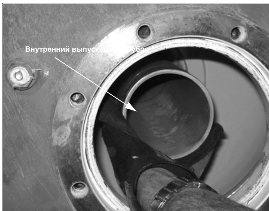
Рис. 20: Проверка воздушной пушки
