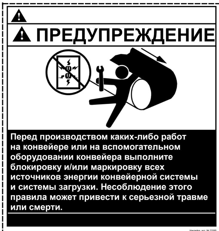
Рис. 23. Предупреждающая наклейка для конвейера и другого оборудования, арт. № 23395
