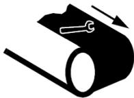
Прежде чем включить источник питания, не забудьте убрать инструменты из зоны установки и с конвейерной ленты. Несоблюдение этого требования может привести к травмам персонала и повреждению конвейерной ленты.
