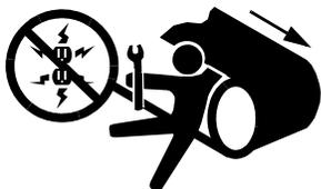
Перед установкой или обслуживанием оборудования отключите, блокируйте источники питания транспортера и связанного с ним оборудования и установите предупредительные таблички.
