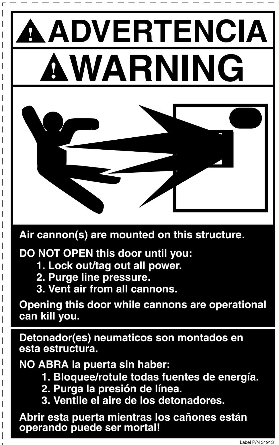
Figure 23. Air Blast Warning Label, P/N 31913
