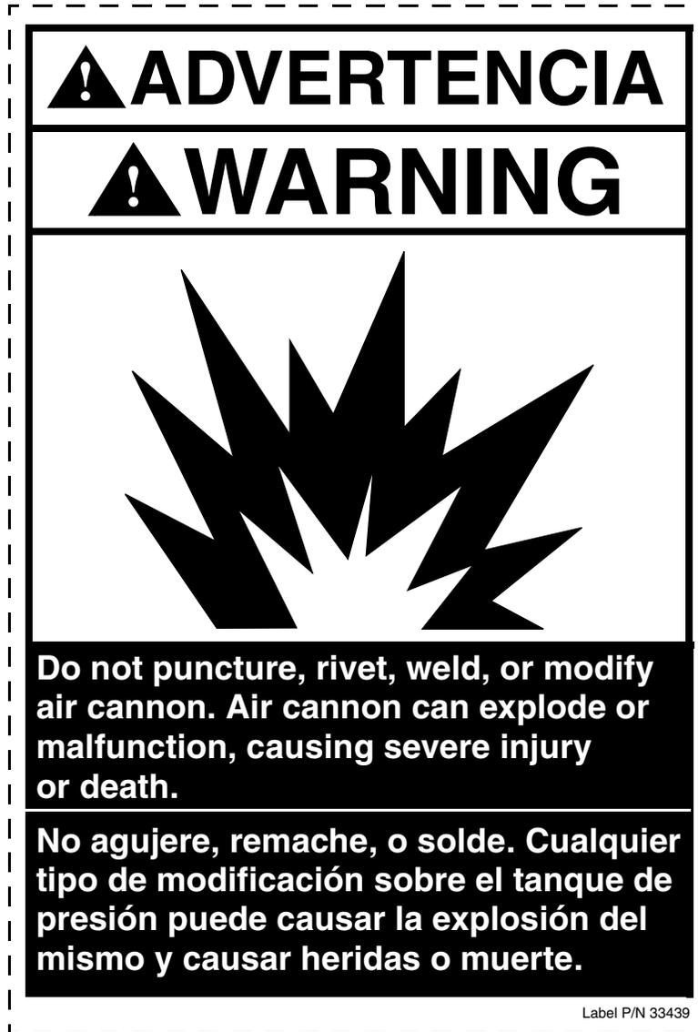
Figure 21. Air Cannon Warning Label, P/N 33439
