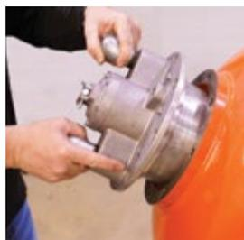
3. Remplacer l'ancienne valve par une valve neuve de canon à air à garantie d'usine de Martin® sortie du « pack de 6 »
