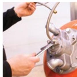
1. Mettre le canon à air hors pression et décharger le réservoir
