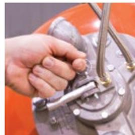
5. Rebrancher les conduites d'air, mettre sous pression, tester la mise à feu
