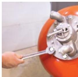
4. Installer le corps de la valve de recharge sur le réservoir
