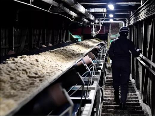
L'exploitation de la biomasse présente des risques d'explosion de poussières, nécessitant un équipement conforme à la norme ATEX pour garantir la sécurité sur le site.
