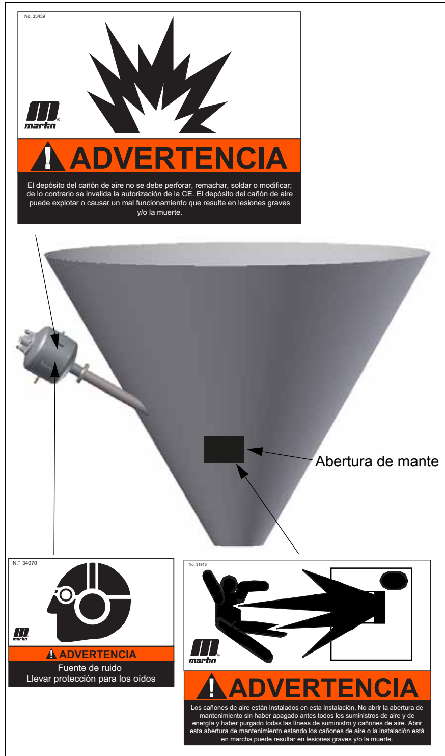
Fig. 11: Adhesivo de advertencia para el cañón de aire MARTIN® Hurricane
