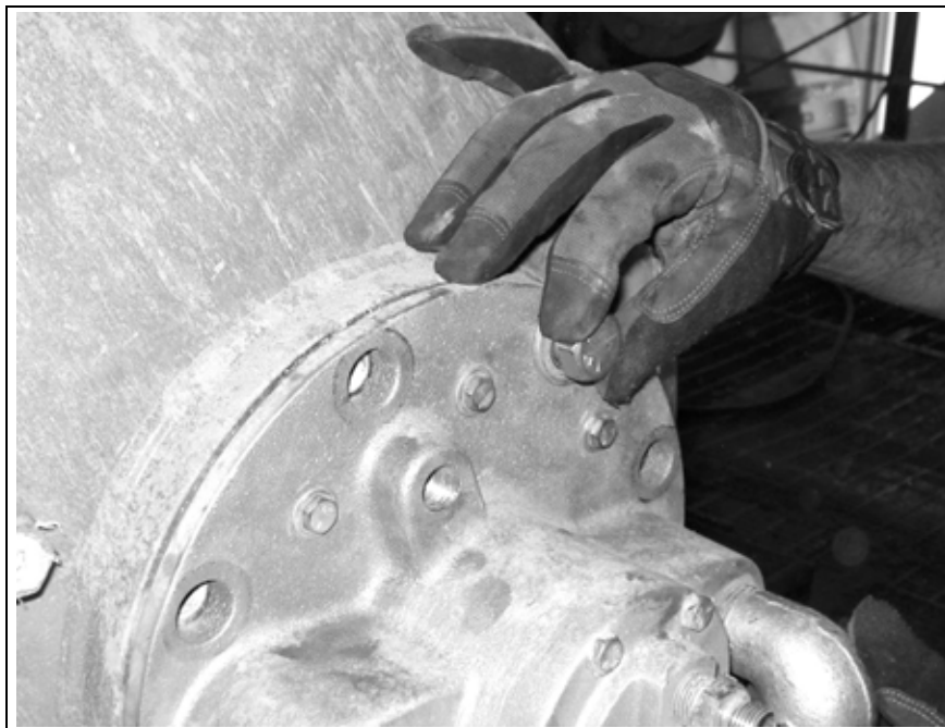
Fig. 21: Colocar los tornillos
