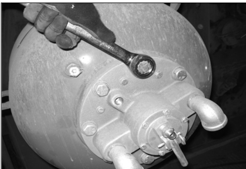
Fig. 15: Retirar los tornillos de la válvula
