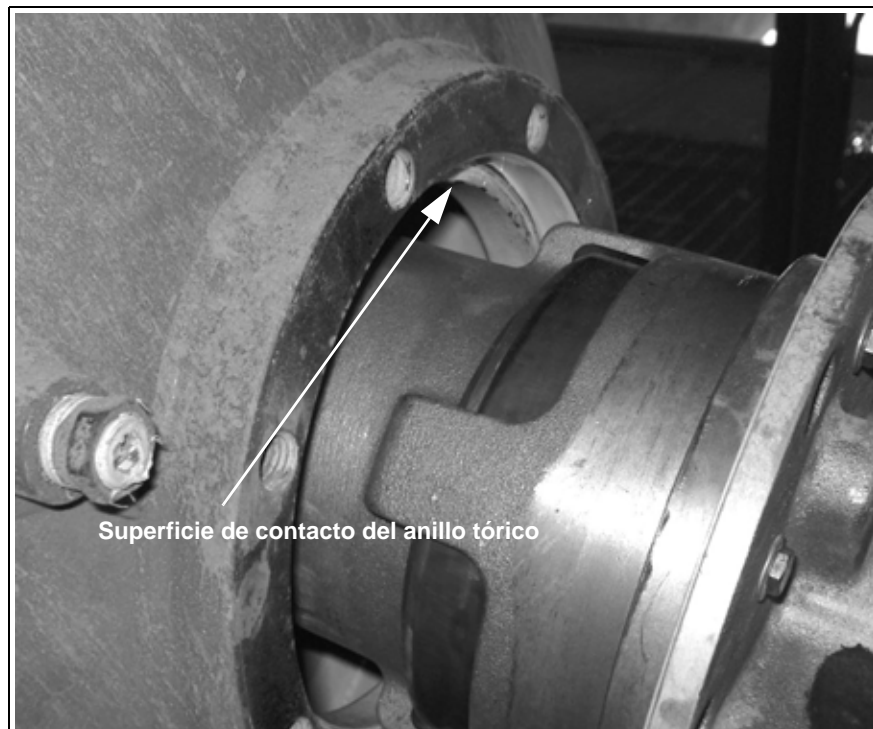
Fig. 20: Insertar la válvula
