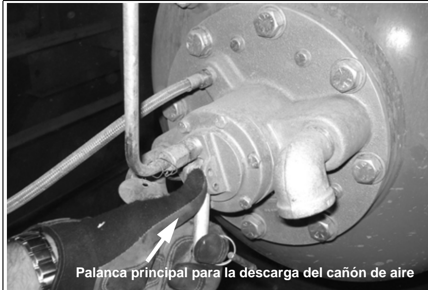
Fig. 12: Descarga del cañón de aire
