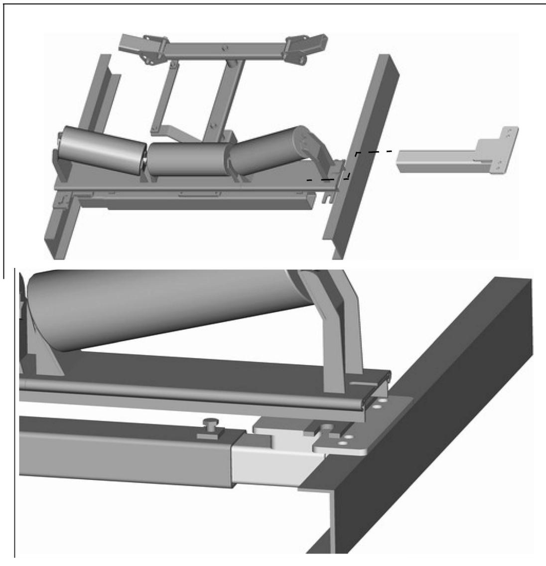
Fig. 18: Montaje del marco de instalación en el lado del operador.
