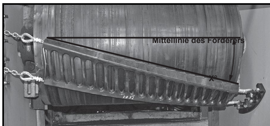
Abbildung 10: Messen des Winkels des Vorabstreifers
