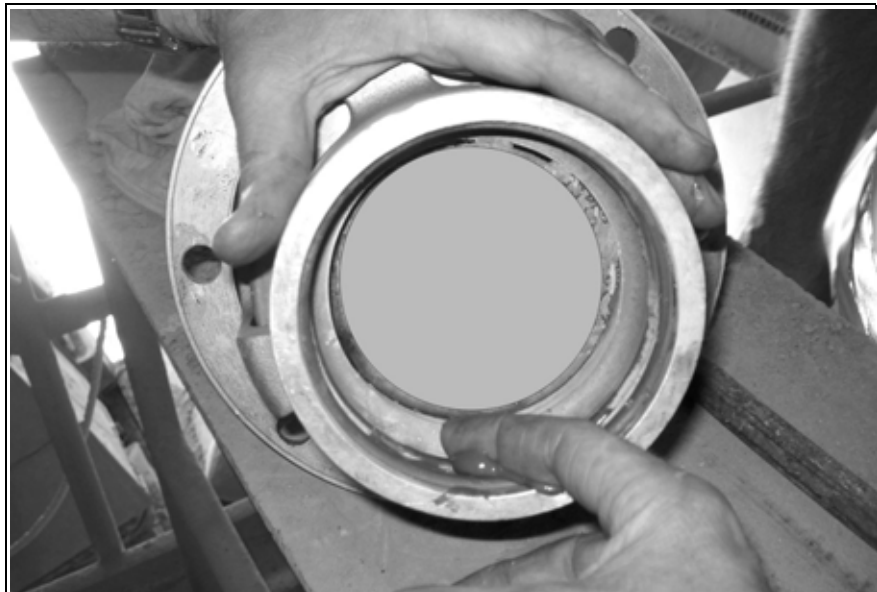
Abb. 18: O-Ringe im Entladungsrohr einfetten
