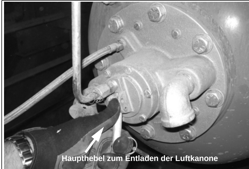
Abb. 12: Entladen der Luftkanone
