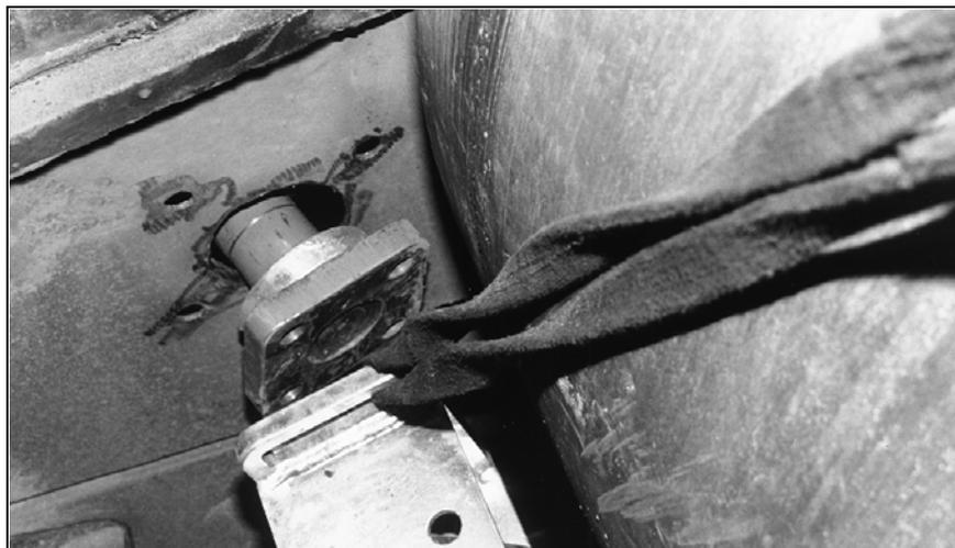
Abb. 6: Ausrichten der Abstreiferachse (1)
