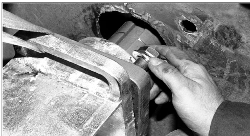
Abb. 7: Ausrichten der Abstreiferachse (2)
