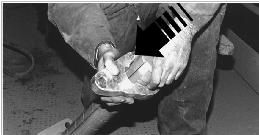
Abb. 2: Installation des Achsendanschlages
