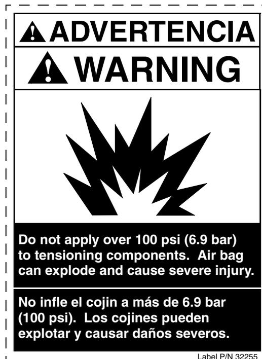
Figure 15. Air Bag Warning Label, P/N 32255
