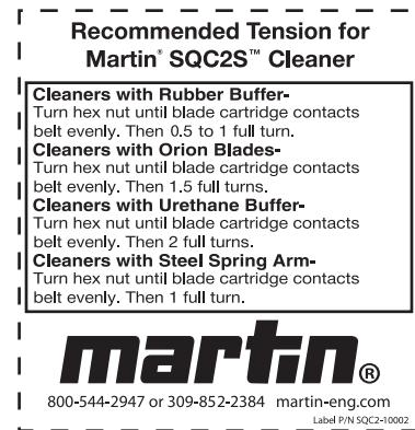
Figure 8. Martin® SQC2S™ Tensioning Label, P/N SQC2-10002
