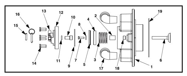
Figure 19. Martin<sup>®</sup> Tornado Air Cannon Exhaust Valve, P/N 37986
