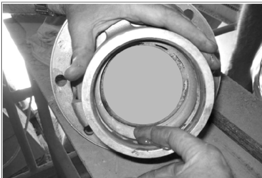
Fig. 18 : Graissage des joints toriques dans la zone de raccordement avec le tube interne
