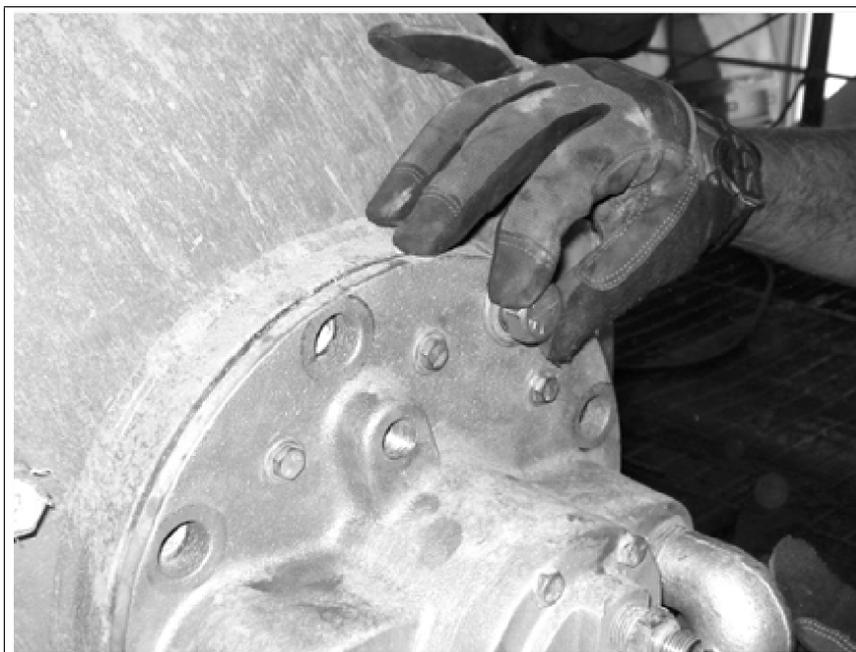
Fig. 21 : Insérer les vis
