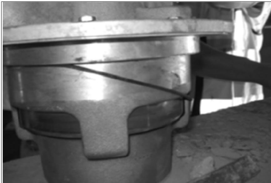
Fig. 17 : Graissage du joint torique
