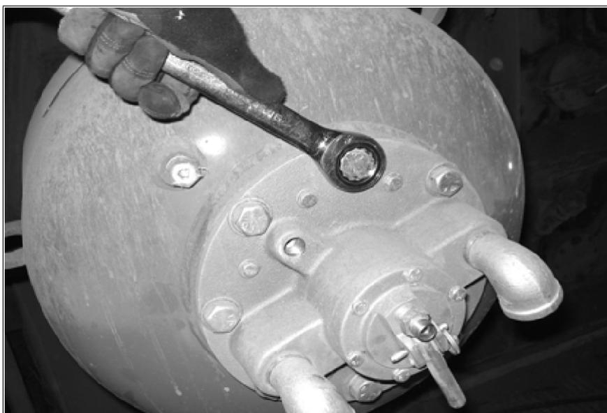
Fig. 15 : Démontage des vis de la tête de déclenchement
