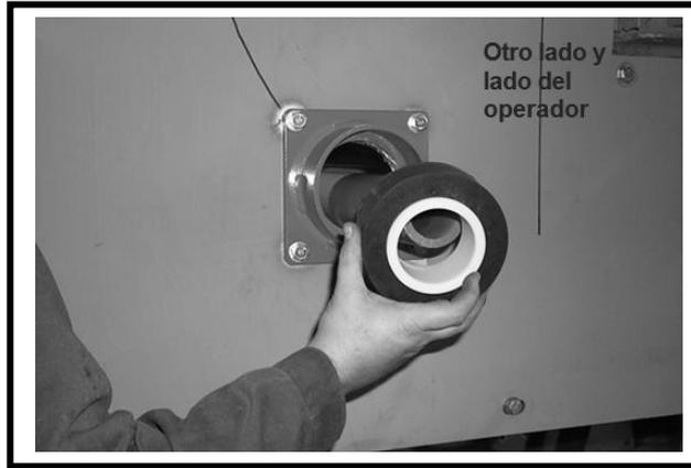
**Figura 5. Instalación de anillos de amortiguamiento.**
