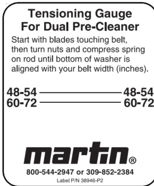
Figura 29. Etiqueta del tensionador mecánico Martin<sup>®</sup> HD Max (tensionadores duales), P/N 38946-P2.
