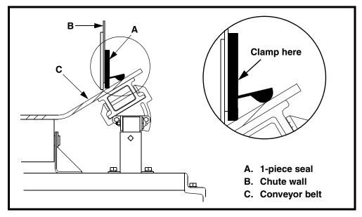
Figure 8. Installing Martin® ApronSeal<sup>TM</sup> Skirting
