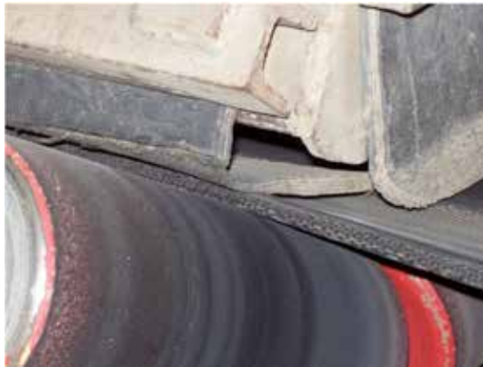
Şekil 5. İçe bakan sızdırmazlık şeklinde kullanılan eski bantlar, toz lastiğiyle bant arasında malzemenin sıkışmasına neden olur Figure 5. Old belting used as a lay-in seal traps material between the seal and belt
