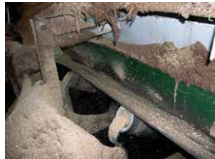
Dökülen ince taneler dönen bileşenleri kirletebilir ve bunlara zarar verebilir Spillage of fines can foul rolling components, causing them to seize
