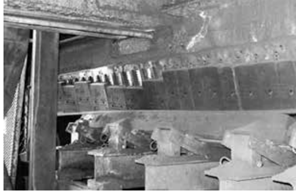
Şekil 4. Parçalı toz lastiklerinde dengesiz aşınma nedeniyle boşluklar oluşur ve bakım ihtiyacı artar Figure 4. Sectional skirting can wear unevenly, causing gaps and increased maintenance
