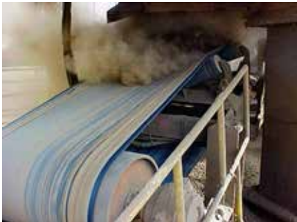
Toz bulabildiği her delikten kaçmaya çalışır. Dust will seek out any gap from which to escape.
