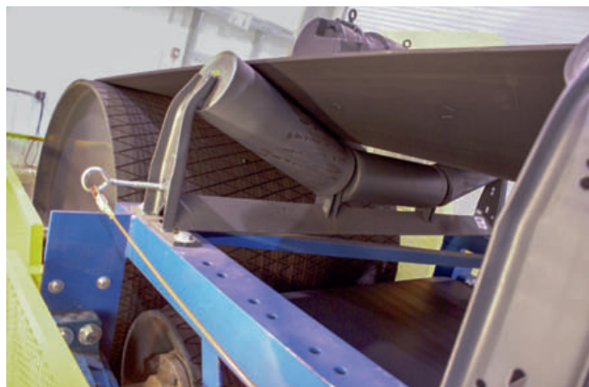
3 Der Quetschpunkt zwischen dem Gurt und einer Tragrolle ist eine Möglichkeit für eine Einklemmverletzung • The pinch point between the belt and a carrying idler is one opportunity for an entrapment injury
