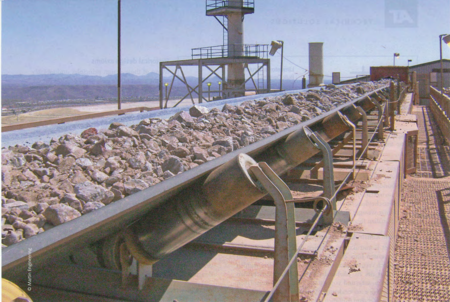
Förderband mit ordnungsgemäßer Beladung und Spurführung Conveyor with proper loading and tracking
