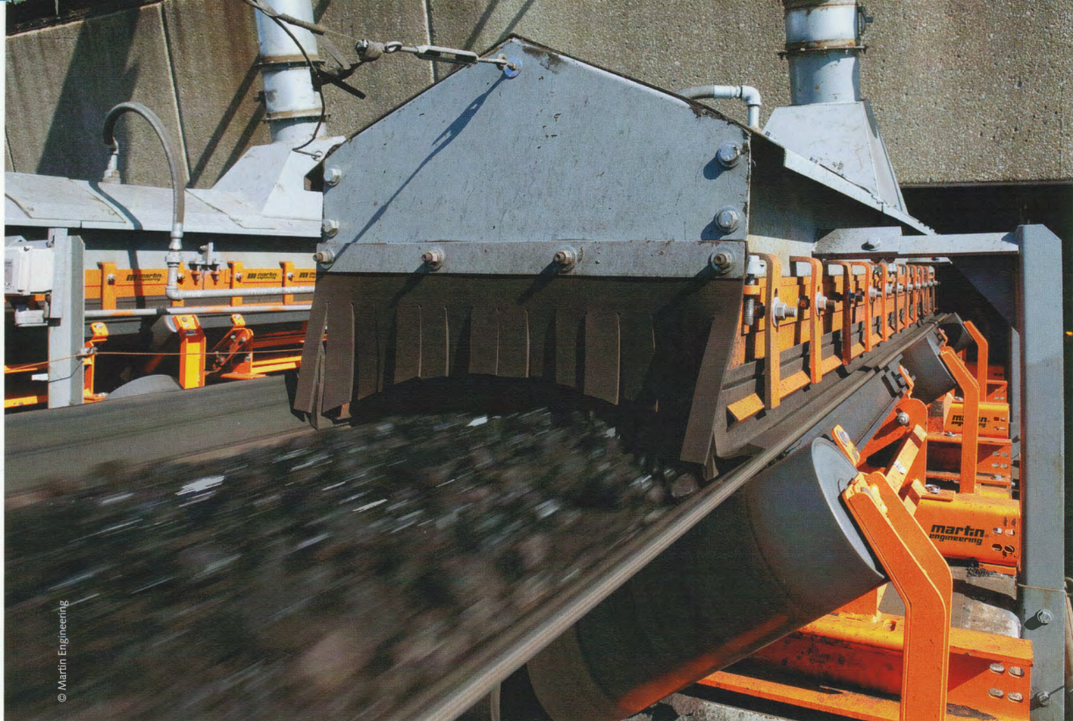
7 Übergabestelle mit Einhausung, Abstützung, Schürzenabdichtung und Staubvorhängen Transfer point with enclosure, support, skirt sealing and dust curtains
