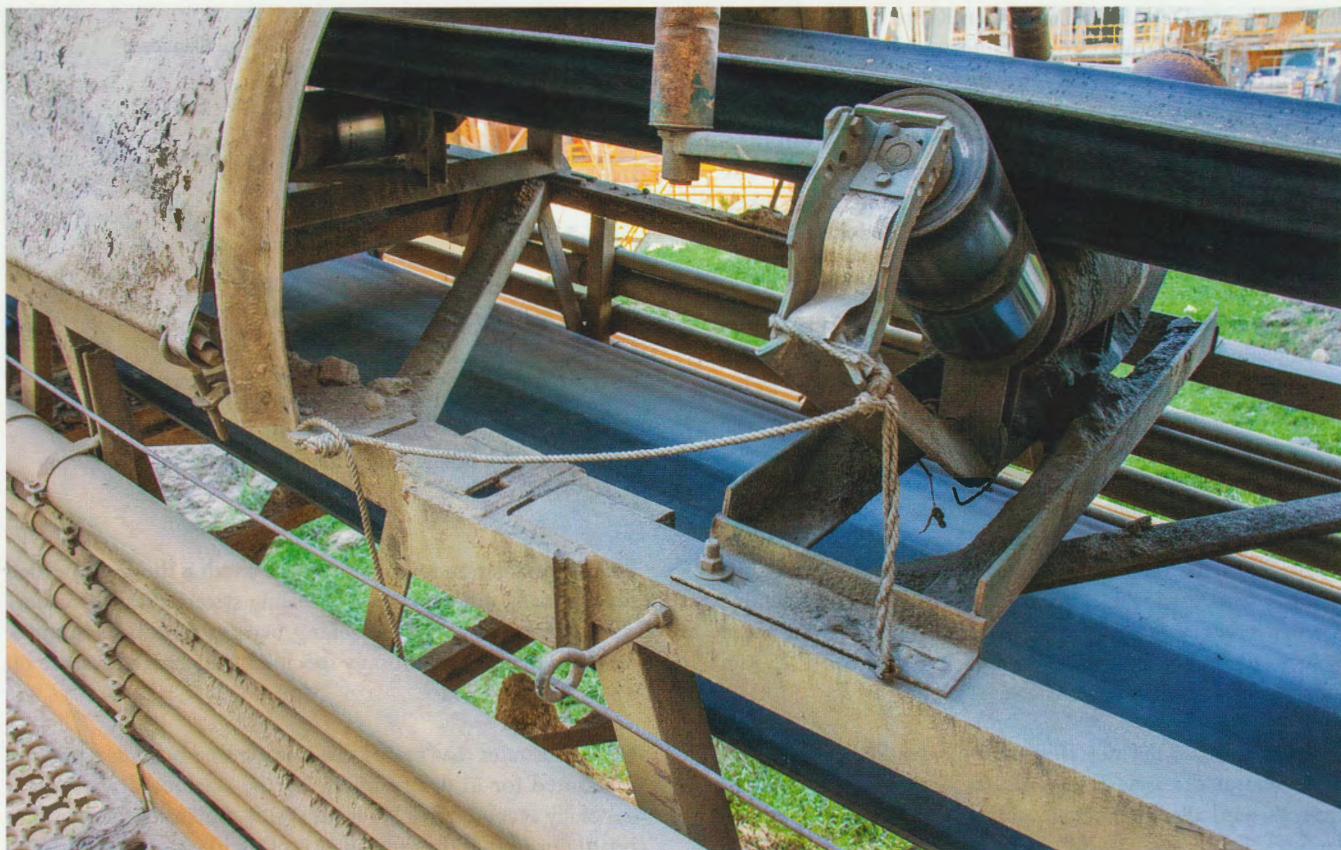
6 Die meisten Probleme mit dem Gurtlauf entstehen durch Fehlausrichtung der Struktur, der Riemenscheiben und der Tragrollen Most belt tracking issues result from misalignment of the structure, pulleys and idlers
