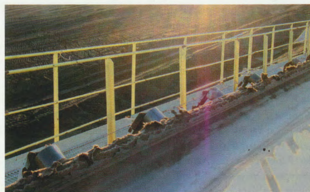
5 Beschädigung der Bandkante durch Versatz Belt edge damage from mistracking
