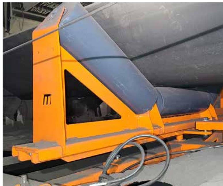
platzieren, um den Gurt zentriert und spurtreu zu halten. Durch die Platzierung einer oberen Einheit vor der Entladung stellen die Betreiber sicher, dass der Gurt auf der Kopfrolle zentriert ist, was eine optimale Gurtreinigung bei maximaler Frachtladung ermöglicht.
