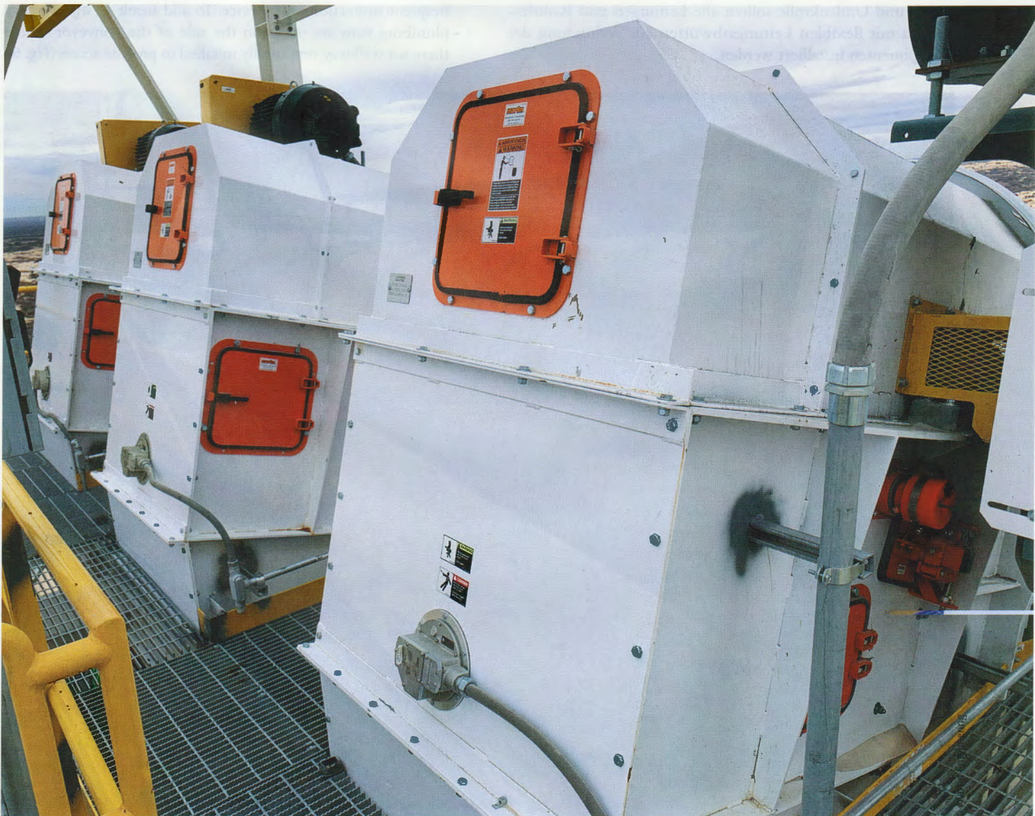
4 Strategisch platzierte Zugangstüren erleichtern Inspektion und Service • Strategically-located access doors facilitate inspection and service
