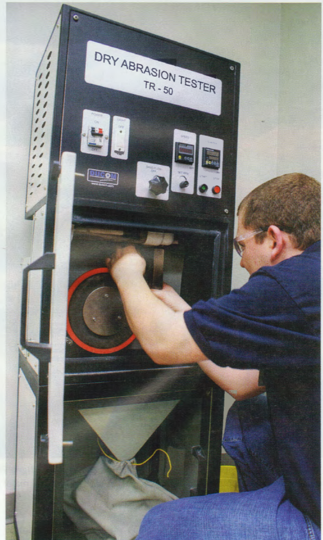
2 Ein Trockenabriebstester prüft den Dreikörper-Abrieb, z.B. zwischen Förderband, Schurrenauskleidung und Schüttgut A dry abrasion tester checks three-body abrasive wear, such as between a conveyor belt, chute liner and bulk material
