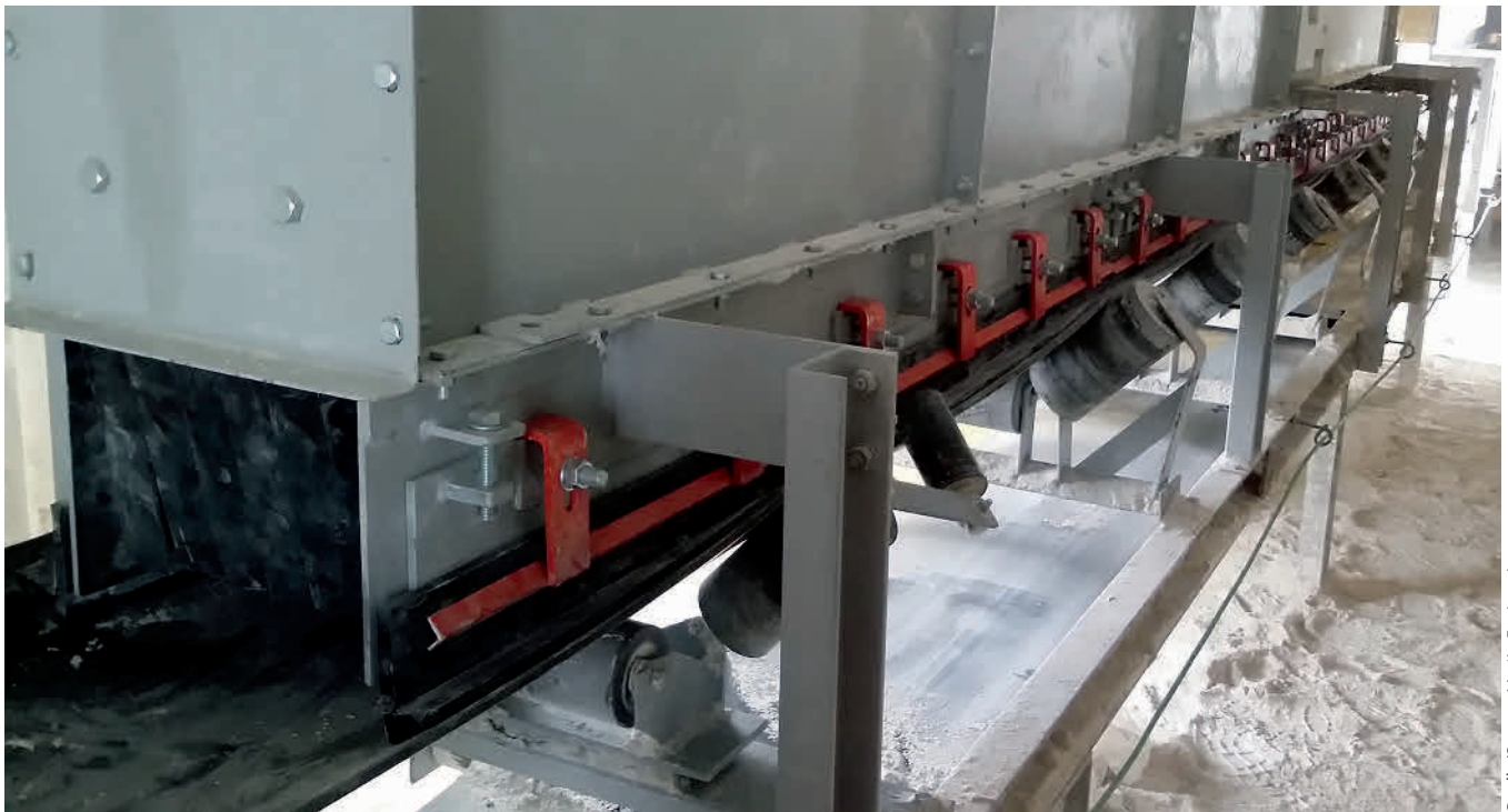
2 Die externe Verschleißplatte und die Seitendichtung helfen, eine Beschädigung der Schurrenwand zu verhindern The external wear liner and apron seal help prevent damage to the chute wall
