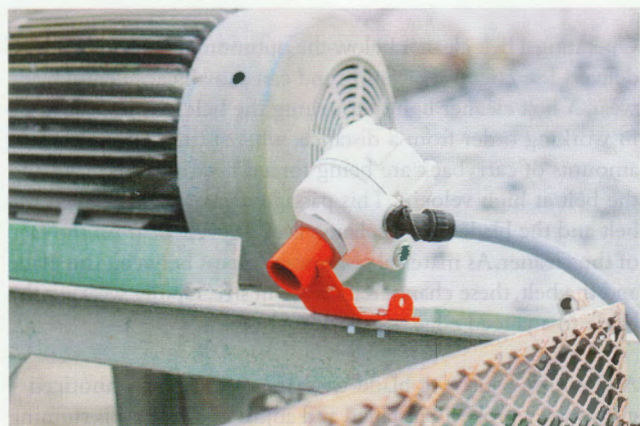
4 Mithilfe von Sensoren kann das Blatt bei Stillständen oder Leerlauf zurückgezogen werden • Sensors can be used to back the blade away during stoppages or when running empty
