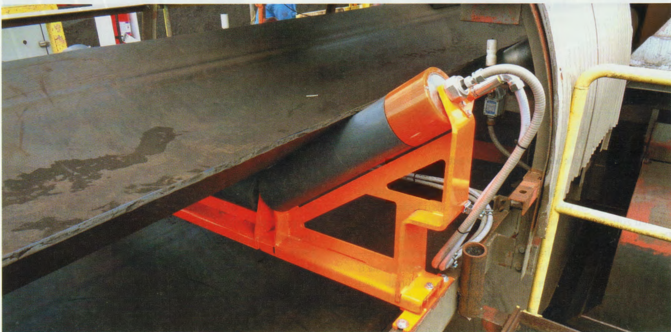
3 Für Standorte ohne Strom oder Druckluft schafft der Rollengenerator ein eigenes kleines Minikraftwerk For locations without electricity or plant air, the Roll Generator creates its own mini-power station
