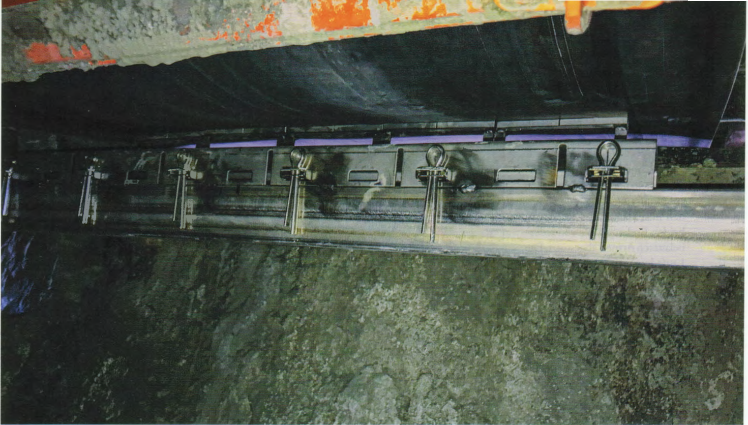
2 Das Edelstahl-Design enthält eine Matrix aus federbelasteten Wolframkarbidspitzen The stainless steel design incorporates a matrix of spring-loaded carbide tips
