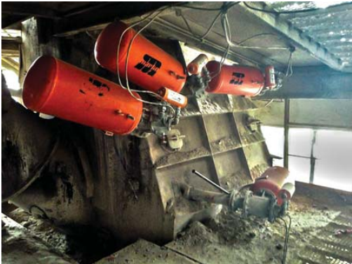
Mevcut 22 Tornado Hava Şoku, işletme maliyetlerini azaltmak için Martin® Piston Geri Dönüş Rezervuarı ile yükseltildi.
