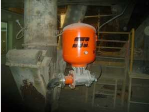
Tornado Egzoz valflerine sahip Martin® Hava Şokları, ön ısıtıcıya yapışan malzemeyi temizlemek için basınçlı havayı kullanır.
