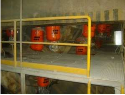
İzmir Türkiye'deki İzmir Çimentoş fabrikasına birkaç iş günü içinde 50 adet Martin® Hava Şoku kuruldu.
