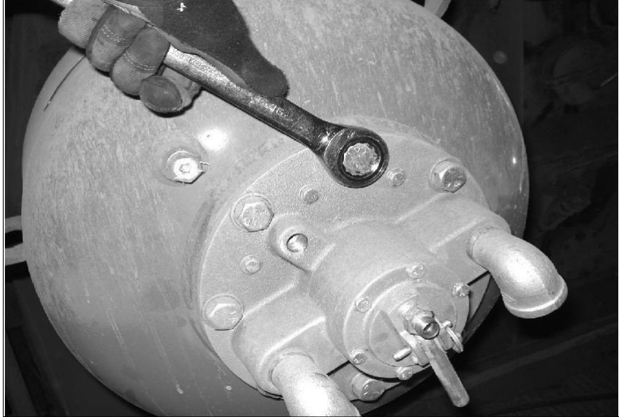
Şekil 15: Valfin civatalarının çıkarılması
