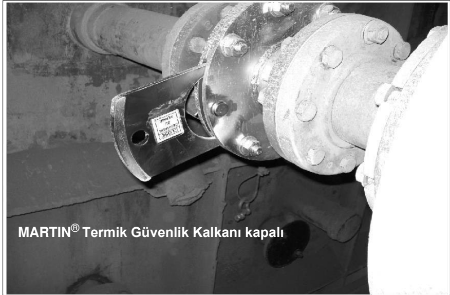
Őekil 13: Termik güvenlik kalkanının kapatılması
