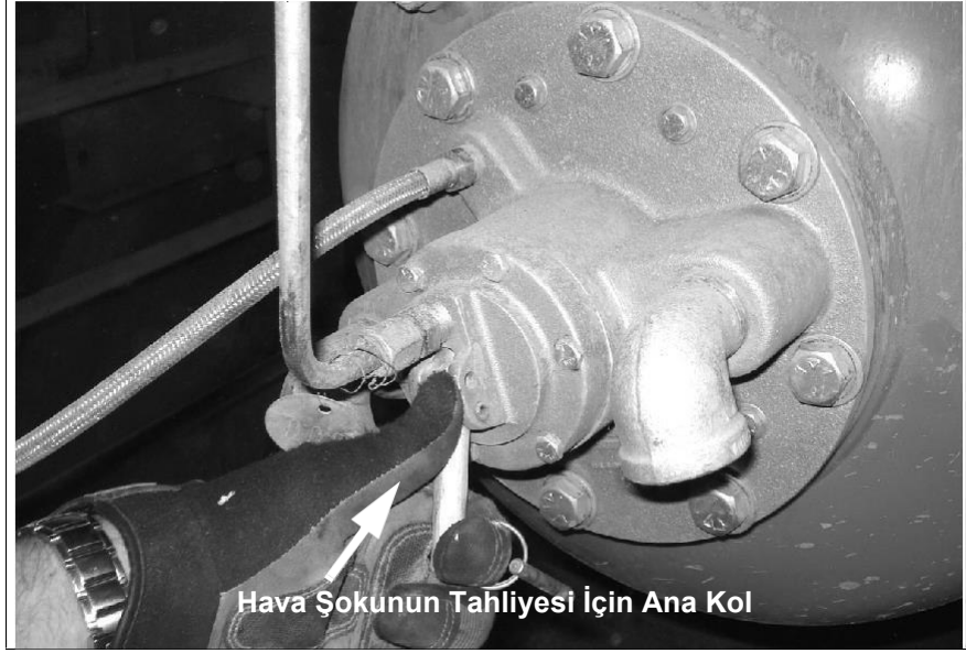
Őekil 12: Hava Őokunun boşaltılması
