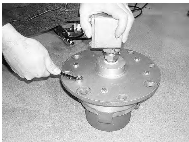
7. Quando repor a válvula no tanque, um pouco de graxa manterá o O-ring. Certifique-se de que o O-ring está seguro durante o processo.
