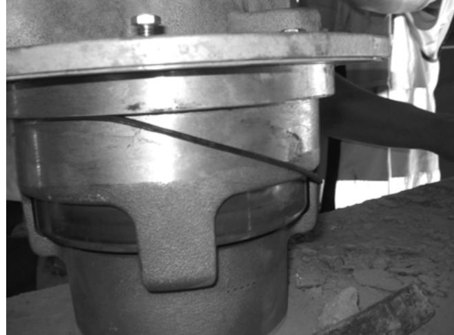
8. Coloque um pouco de graxa no tubo de descarga O-rings.
