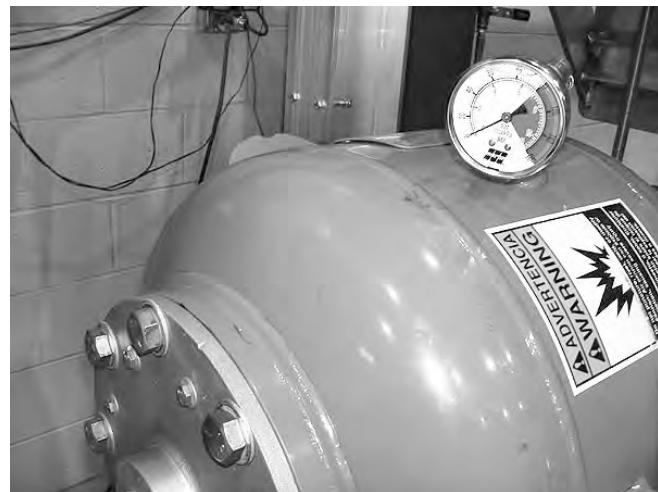
2. Feche a trava de segurança, se houver. Se o seu canhão de ar tiver uma porta de descarga aberta, certifique-se que estejam seguramente isoladas de fluxo de material ou riscos dentro da área de descarga.
