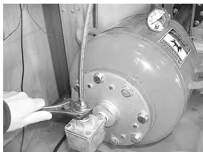
4. Remova os 8 parafusos da válvula.
