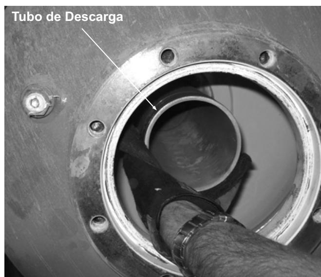
10. Coloque a válvula novamente no tubo de descarga, certifique-se que o O-ring não seja apertado.
