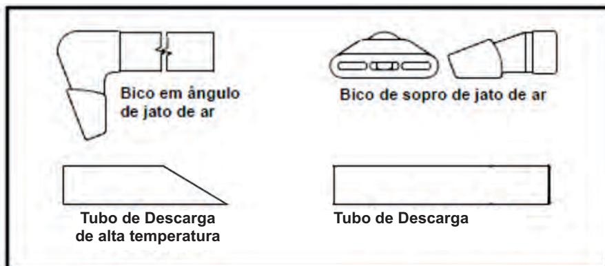
**Figura 8. Tubos/ Bicos de montagem**
