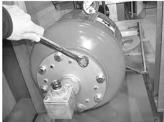
12. Após a válvula estar presa ao tanque, reconecte as linhas de ar. Garanta de que não tenha vazamentos nem conexões soltas.
