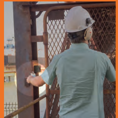
Um trabalhador utiliza a etiqueta RFID em seu cartão de identificação para ter acesso ao transportador.
