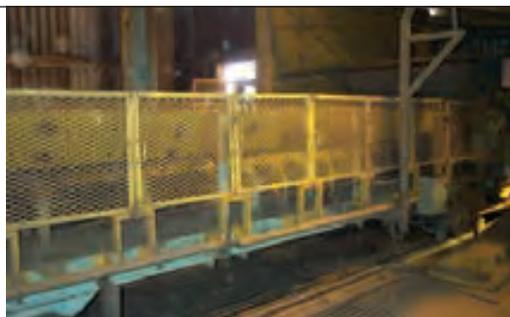
Geralmente, barreiras de proteção exigem uma ferramenta para remoção e podem incluir um sinal indicando qual equipamento deve ser isolado (ou seja, travado/sinalizado/bloqueado/testado) antes que a proteção possa ser removida. A inspeção visual dos componentes do transportador de correia e o acesso a pontos de lubrificação devem ser possíveis sem remoção das barreiras protetoras (**Figura 26.7**).
