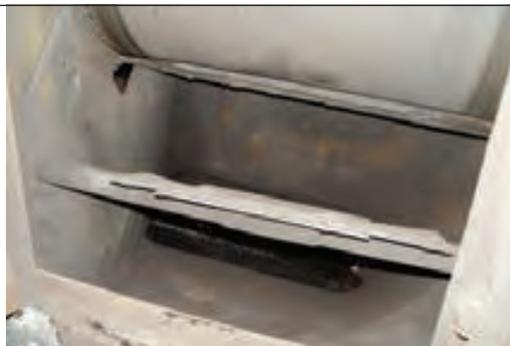
Os materiais subsequentes são desviados por essa pilha. A força de abrasão que seria exercida sobre a parede do chute passa para a pilha de material acumulado, e a altura total de queda é reduzida, dissipando a força do impacto à medida que o material quica na pilha (**Figura 8.16**).
