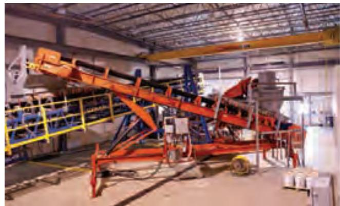
O sistema transportador de recirculação em três partes, no Centro de Inovações Martin para o Manuseio de Material a Granel, leva em conta o teste de manuseio de materiais escala natural.
