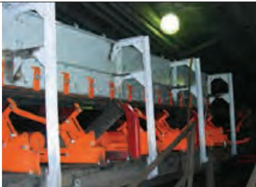
receptora com velocidade e ângulo adequados, o chute com curva inferior reduz impacto e queimadura da correia, geração de pó, carga fora de centro, uso de placas de desgaste e outros problemas (**Figura 22.6**).
