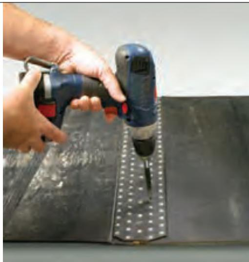
utiliza polias menores que 300 milímetros de diâmetro. Nesse caso, os fixadores tipo placa sólida podem ser grandes demais para se curvarem em volta da polia, causando o rompimento dos componentes da emenda.
