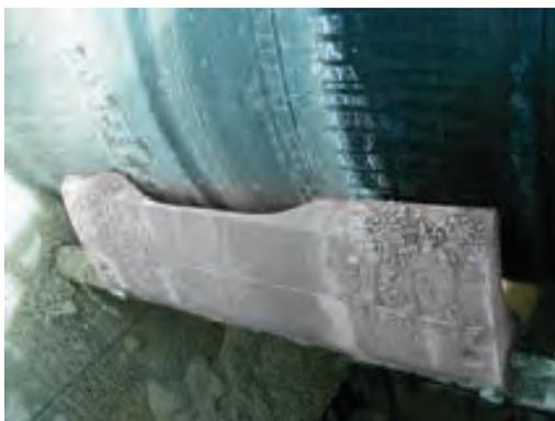
Reduzir a cobertura da lâmina na correia pode ajudar a aliviar o problema de aquecimento. No entanto, deve-se tomar cuidado ao reduzir a cobertura da lâmina, especialmente na correia salientada. Se a correia enroscar sobre a cobertura de uma lâmina do raspador, ela fica exposta ao corte da lâmina. Alguns raspadores usam uma lâmina não metálica mais flexível nas pontas exteriores para evitar esse problema. Outra solução é manter a correia plana com o uso de rolamentos de retenção (Figura 14.17).
