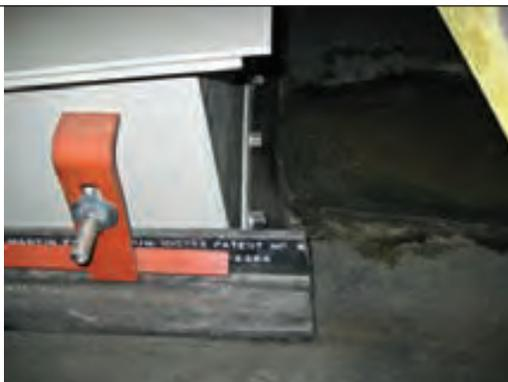
correia durante o percurso de volta da polia de descarga. O material retirado por esse efeito “raspador de correia” irá, então, acumular-se no ponto onde a correia entra na zona de carga (Figura 6.23) ou, se o transportador estiver inclinado, rolará pela correia e se acumulará na parte traseira do transportador (Figura 6.24).
