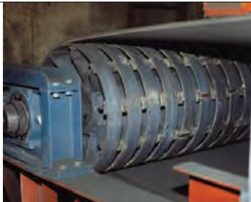
A melhor solução para evitar acúmulo de material sobre polias traseiras é usar uma polia de aço sólida e plana, protegida por um dispositivo de limpeza situado em frente à polia (**Figura 6.7**). Esse tipo de raspador diagonal ou em V deve ser colocado imediatamente antes da polia traseira, no lado não transportador da correia, para remover qualquer material fugitivo que possa ser transportado na parte interior da correia. (*Veja o Capítulo 15: Raspadores de Proteção das Polias.*)
