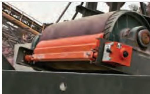
ajuste de potência, como uma bolsa de ar, que pode ser controlada remotamente/a distância. Os tensionadores lineares mantêm um ângulo de limpeza constante, conforme a lâmina se desgasta, e podem ser projetadas para considerar uma retirada/extração fácil do raspador para manutenção, sem remover a roldana.
