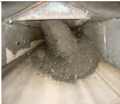
**(Figura 16.11).** Quando a carga da correia não está centralizada, o peso da carga empurra a correia para o lado com carga mais leve do transportador. Isso pode ser corrigido por ajustes apropriados no chute de carregamento ou através do uso de desviadores, grades ou fundo do chute, que podem ser ajustados para corrigir a colocação da carga sobre a correia. (Consultar Capítulo 8: Chutes de Transferência Convencionais.)
