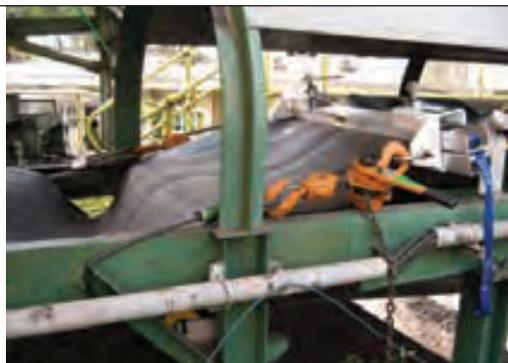
podem ser utilizados para restringir fisicamente a correia, prendendo o aparelho de bloqueio a uma parte estrutural do transportador capaz de resistir às forças esperadas (**Figura 2.6**).
