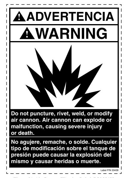
Figure 21. Air Cannon Warning Label, P/N 33439
