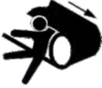
No toque ni se acerque a la banda transportadora o a los componentes del transportador cuando la banda esté en marcha. El cuerpo o la ropa pueden quedarse atrapados en la banda transportadora, causando lesiones graves o la muerte.
