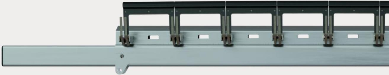
Los limpiadores primarios de banda con hojas de uretano suelen eliminar entre el 50 y el 70% del material de retorno. En algunas aplicaciones, esta reducción en el material de arrastre es adecuada para mantener las operaciones del transportador limpias, seguras y productivas. En otros casos, pueden ser necesarios limpiadores secundarios e incluso terciarios de para garantizar una limpieza y un funcionamiento óptimos.
