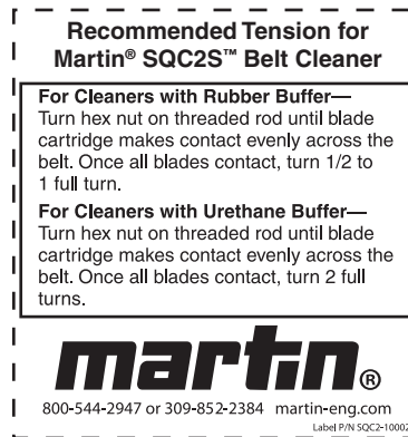
Figura 8. Etiqueta de tensionamento Martin® SQC2S™, P/N SQC2-10002
