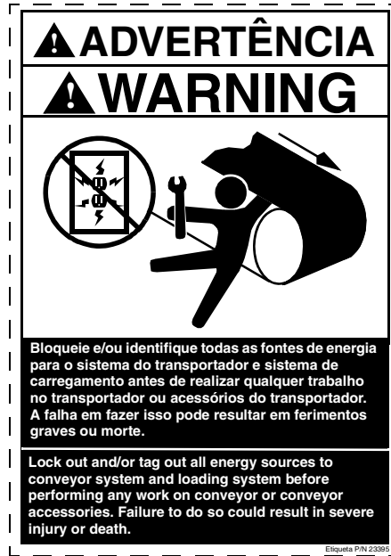
Figura 7. Etiqueta de aviso dos produtos do transportador, P/N 23395
