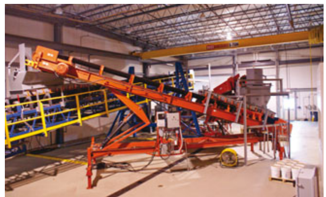
Im Martin Engineering Innovationszentrum für die Schüttguthandhabung (CFI) steht für Forschungs- und Versuchszwecke ein dreiteiliges Fördersystem mit Rücklauf im Industriemaßstab zur Verfügung.
