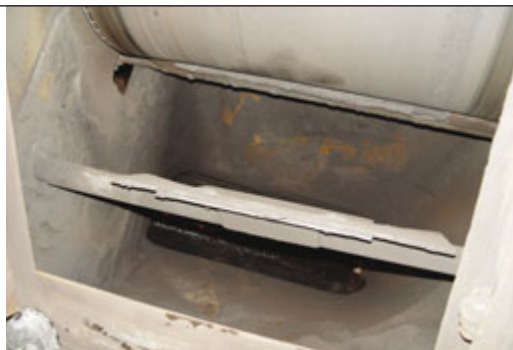
Abbildung 8.13 Leitbleche werden zur Absorption der Impulskräfte und zur Reduzierung des Verschleißes in einer Schurre verwendet.
