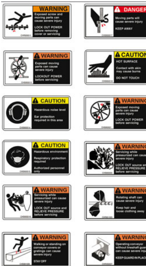
Abbildung 2.12 In die Beschilderung zur Gefahrenkennzeichnung sind selbsterklärende Piktogramme zu integrieren. Damit wird die Inhalt der Beschilderung verständlicher und wird alle Mitarbeiter wirksamer schützen, auch wenn an der Anlage mehrere Sprachen gesprochen werden.
