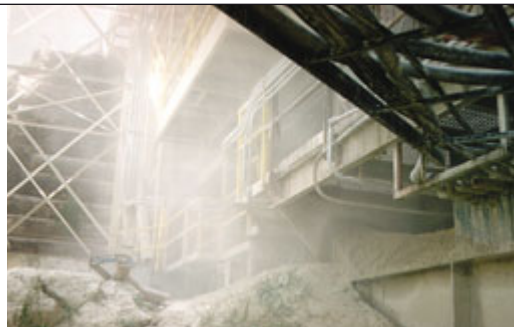
Abbildung 1.9 Staubemissionen aus Förderanlagen und Übergaben stellen ein ernsthaftes Problem dar.
