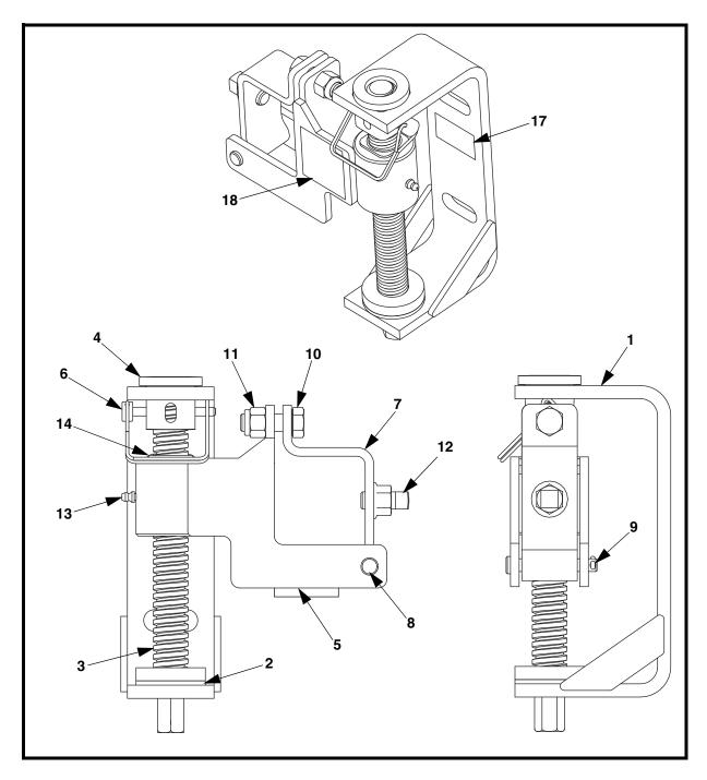
Figure 1. Martin<sup>®</sup> SQC2S<sup>TM</sup> Square Mainframe Tensioner Assembly, P/N 38664
