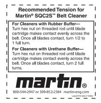
Figure 4. Martin<sup>®</sup> SQC2S<sup>TM</sup> Tensioning Label, P/N SQC2-10002
